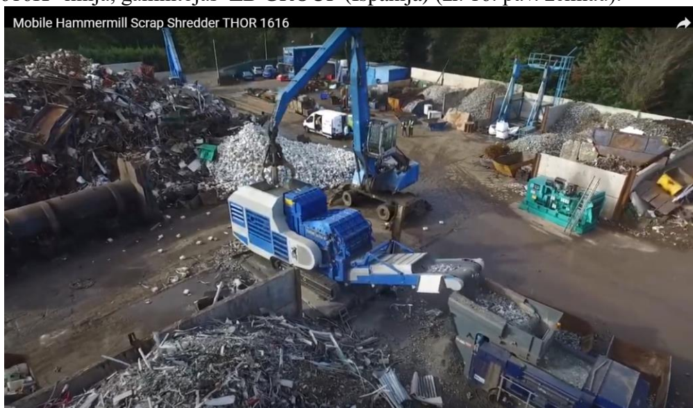
16. Pav. Mobilus smulkintuvas (šrederis) „THOR1616K“ kartu su moduliniais segmentais vaizdas
