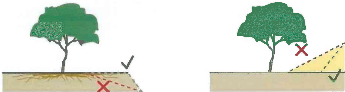
35 pav. Pasirenkant tinkamus techninius sprendinius, formuojant iškasas ir sankasas, galima išsaugoti dalį medžio šaknų
