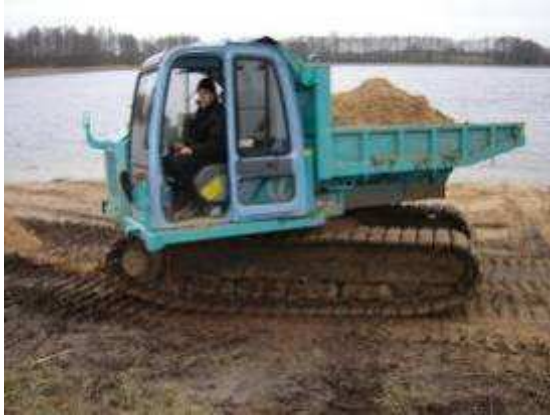
38 pav. Savaeigės priekabos CD60R ir CG150 gruntui iš pelkių transportuoti.
