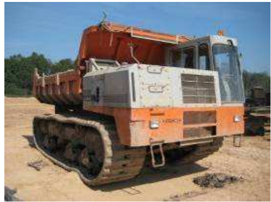
38 pav. Savaeigės priekabos CD60R ir CG150 gruntui iš pelkių transportuoti.
