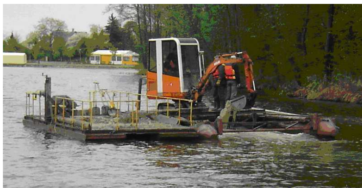
36 pav. Ant plūdurių pastatytas mini ekskavatorius gal valyti ežerų pakraščius.
