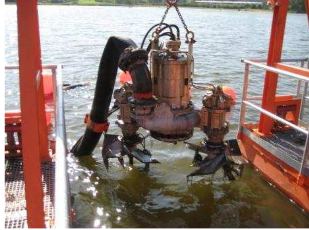
15 pav. Vokiška žemsiurbė „Christa Wendland“ su originalios konstrukcijos siurbliu, galinčiu kasti ne tik dumblą, bet ir žvyrą, valo Talkšos ežerą (Šiauliai), 2007 m.
