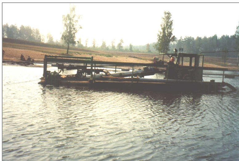
13 pav. LŽŪU Vandentvarkos katedros konstrukcijos žemsiurbė VT – 2 su panardinamu siurbliu, kuris sukamas kardaniniu vėlu nuo elektros variklio.
