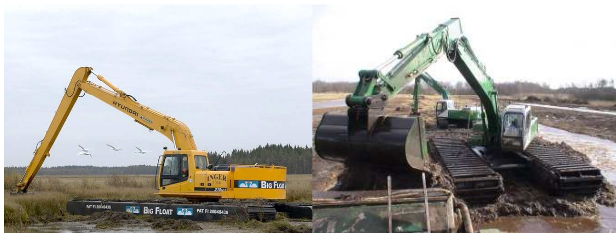
35 pav. Ekskavatorius su vikšrais- plūdurais “Big Float” skirtas darbui sunkiai prieinamose užpelkėjusiose vietose
