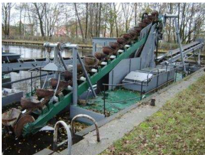
31 pav. Daugiauškė žemkasė vandens telkinių valymui (Lenkija)
