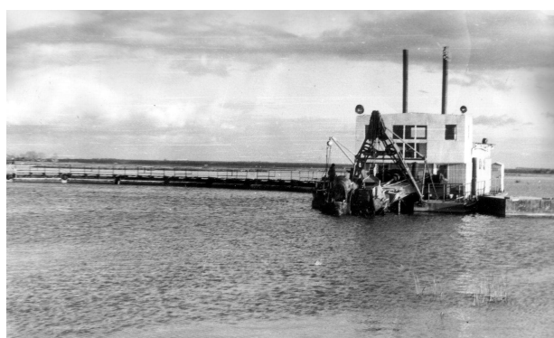
14 pav. Žemsiurbė 350 – 50L (Rusija) su rotoriniu kaušiniu purentuvu a) schema, b) – darbo metu Nero ežere (Jeroslavlio sritis, Rusija), 1982 m.
