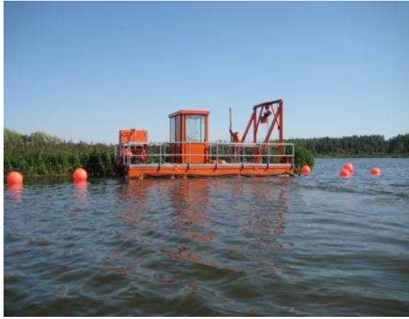
15 pav. Vokiška žemsiurbė „Christa Wendland“ su originalios konstrukcijos siurbliu, galinčiu kasti ne tik dumblą, bet ir žvyrą, valo Talkšos ežerą (Šiauliai), 2007 m.
