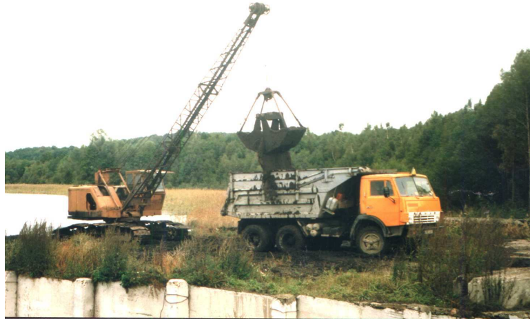
28 pav. Sapropelis ekskavatoriumi su greiferiniu kaušu iškraunamas iš baržos ir supilamas į savivartę mašiną.
