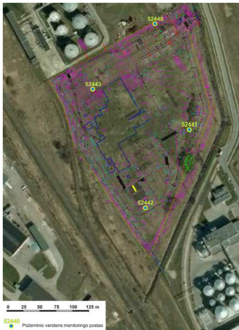
2.20 pav. Klaipėdos termofikacinės jėgainės teritorijos poveikio požeminiam (gruntiniam) vandeniui monitoringo postų schema [39]
