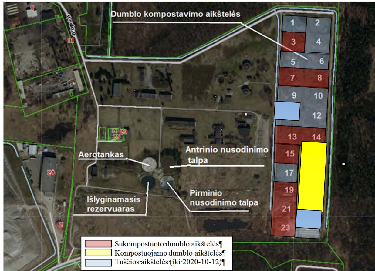
11 pav. Nuotekų valymo baro planas su dumblo kompostavimo aikštelėmis
