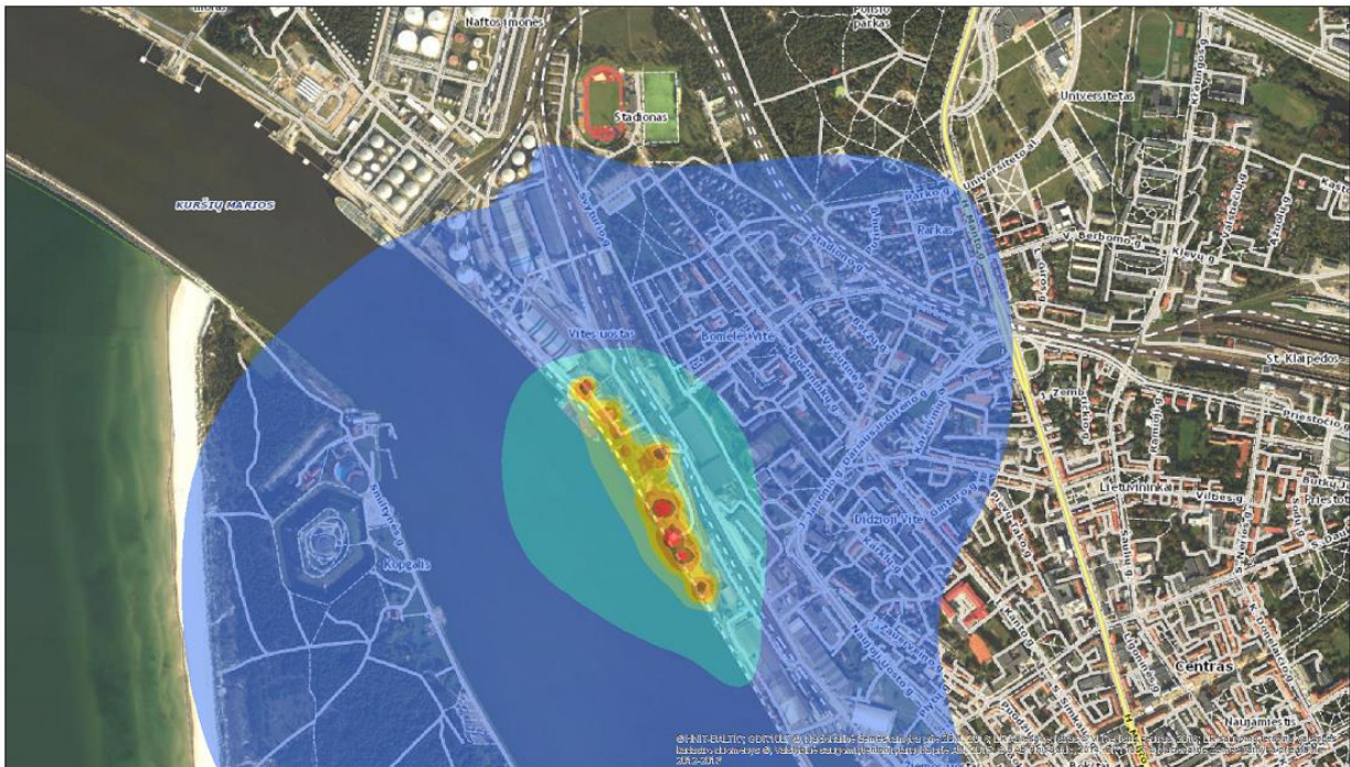
Vidutinė 24 val. KD10 koncentracija ( \mu\text{g}/\text{m}^3 ) aplinkos ore (12 šaltinių, emisija 0,1 g/s, DRY1_scenario). Ribinė metinė vertė 40 \mu\text{g}/\text{m}^3 Sumodeliuota periodui: nuo 2020.05.28 iki 2020.07.10 (1056 val.) AB KLASCO aplinkoje, įskaitant foninius duomenis. 1:8 000
