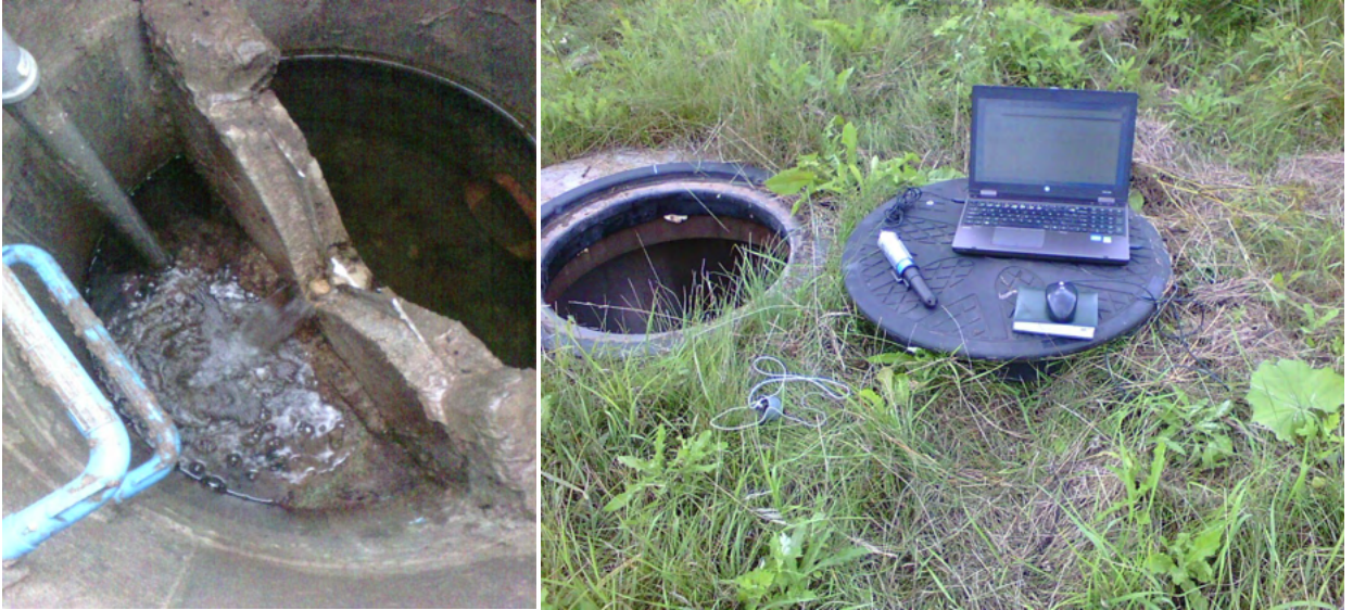
2.3.1.1 pav. Vandens lygio palaikymo tvenkinėlyje šulinėlis su trikampine nuopyla, šalia vamzdyje įleistas lygio matuoklis ir jo rodmenų nuskaitymas nešiojamo kompiuterio pagalba.
