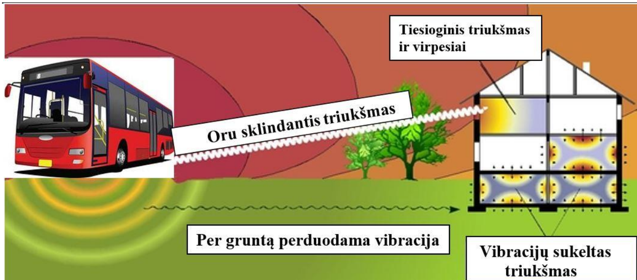
Pav. 12.7 Vibracijų ir triukšmo perdavimo iš triukšmo šaltinio priėmėjui iliustracija (adaptuota iliustracija pagal informacijos šaltinį: http://www.rivas-project.eu/index.php?id=4 )
