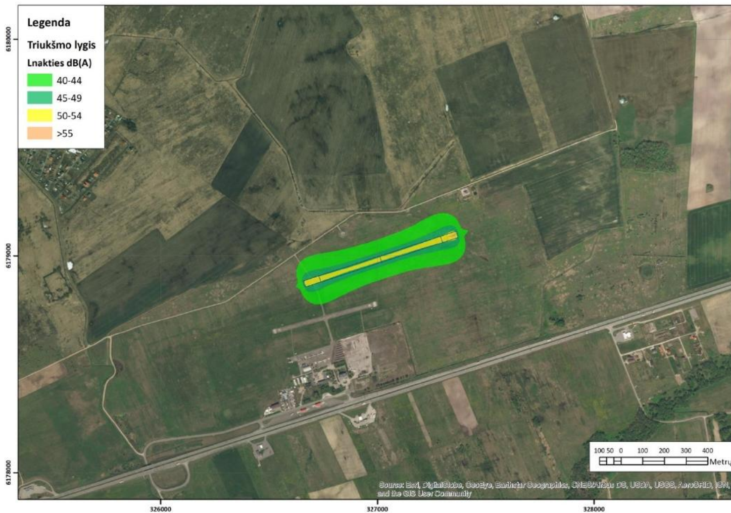
4 pav. Klaipėdos aerodromo pagrindiniu lėktuvų kilimo tūpimo taku, perkeliama į gruntinio (atsarginio) tako vietą, kylančių ir besileidžiančių lėktuvų prognozuojamas triukšmo lygis ( L_{nakties} triukšmo rodiklis)
