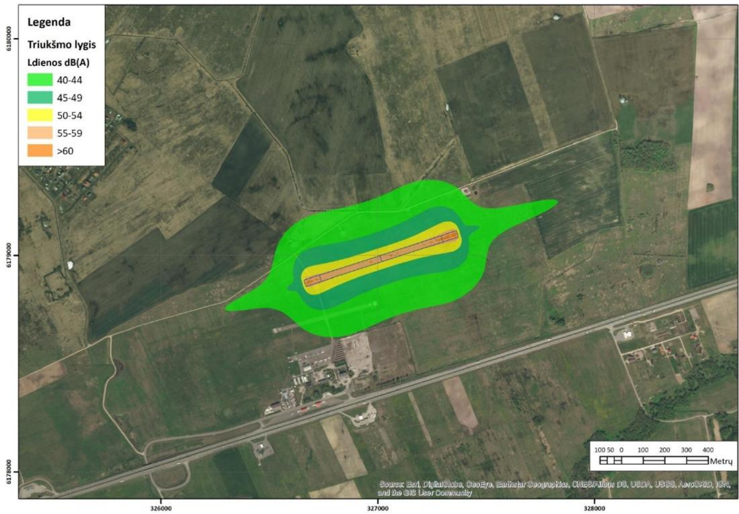
2 pav. Klaipėdos aerodromo pagrindiniu lėktuvų kilimo tūpimo taku, perkeliamu į gruntinio (atsarginio) tako vietą, kylančių ir besileidžiančių lėktuvų prognozuojamas triukšmo lygis (Ldienes triukšmo rodiklis)
