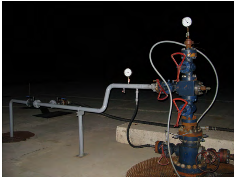
5.10.3 pav. Naftos gavybos gręžinio sraigtinis siurblys
