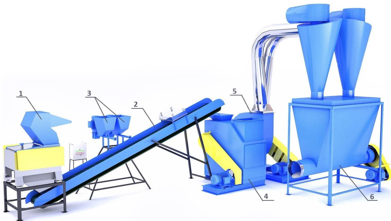
1 pav. „Ekovatos“ gamybai planuojama naudoti technologinė įranga. 1 – šrederis, 2 – konvejeris, 3 – dozatorius, 4 aerodinaminis dispergatorius, 5 – aukšto slėgio ventiliatorius, 6 – pagamintos produkcijos bunkeris.
