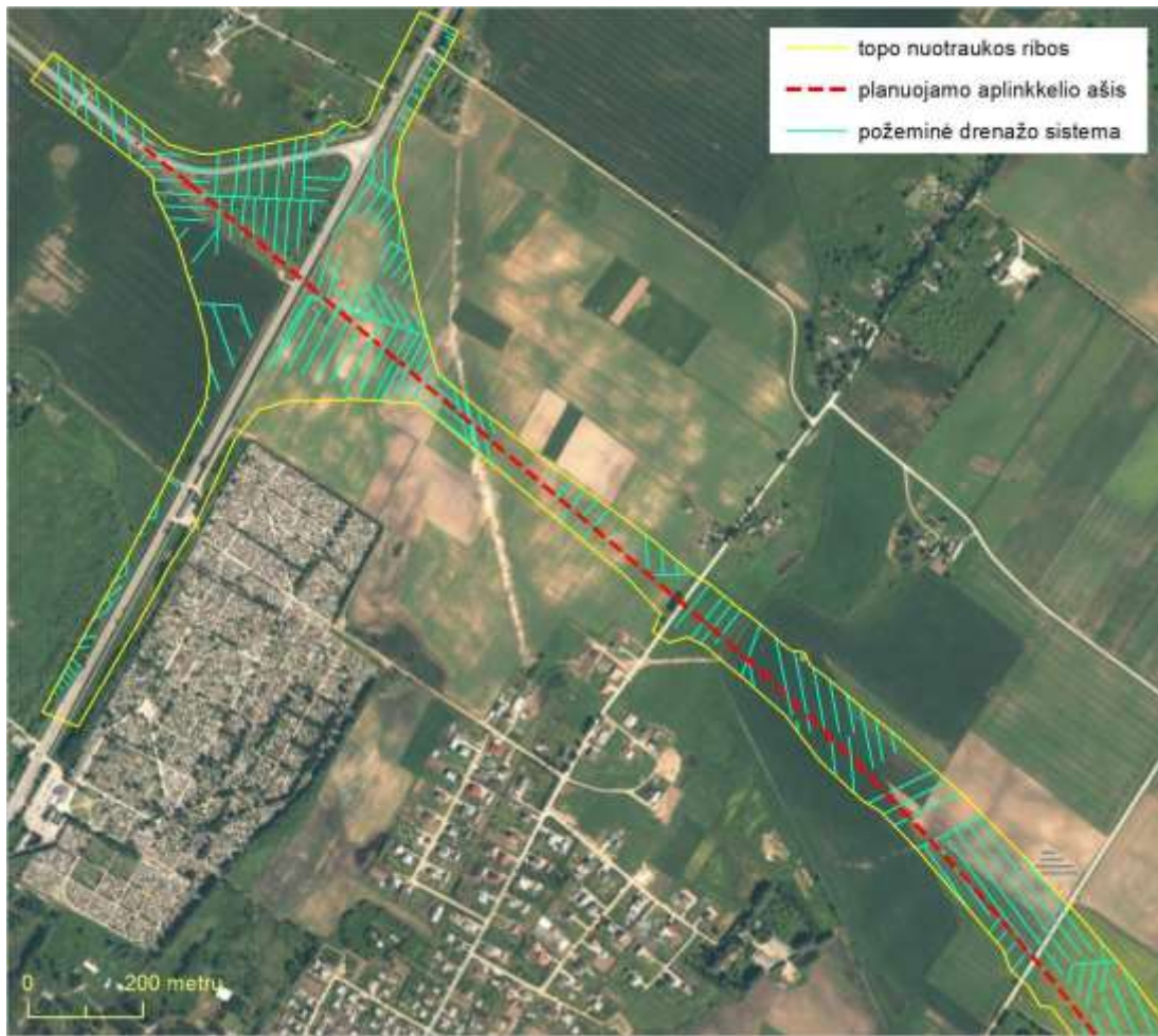
21. pav. Parengtos topo nuotraukos fragmentas. Išskirta požeminio drenažo sistema
