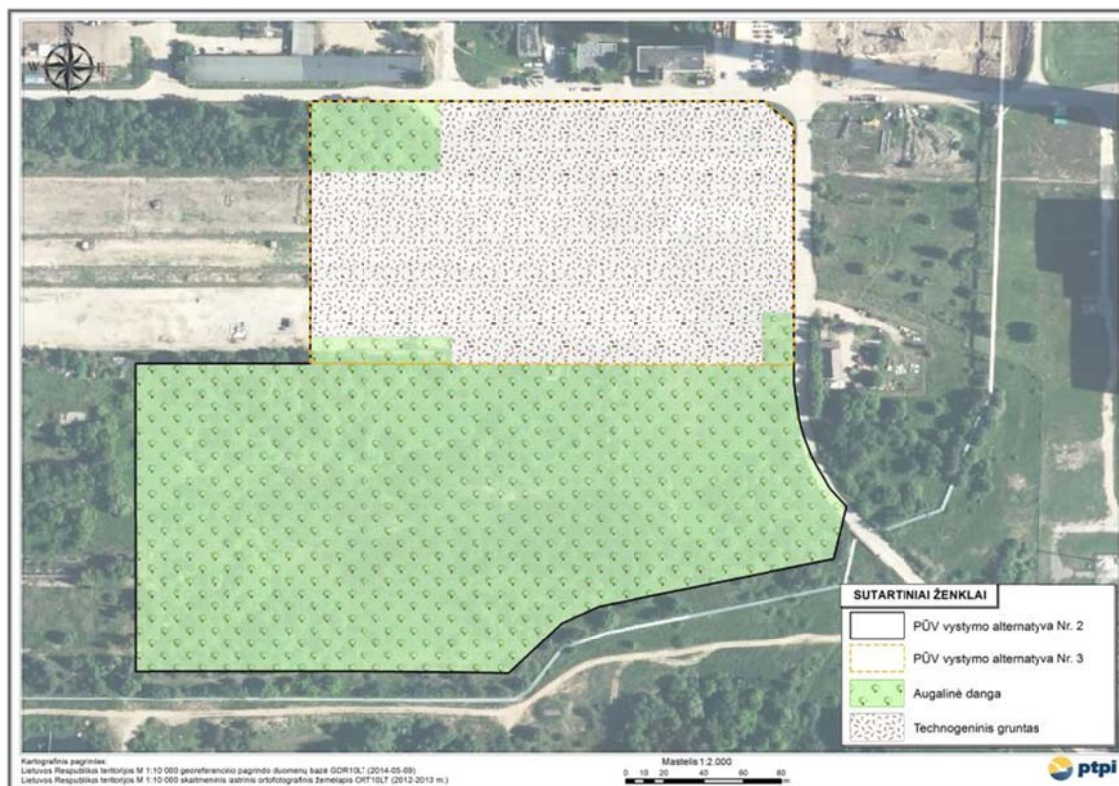
Pav. 4.3.2. Vyraujantis paviršiaus danga analizuojamoje planuojamos naudoti žemės sklypo dalies teritorijoje.
