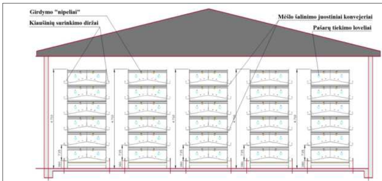
11 pav. Vištu laikymo narvų išdėstymo vištideje pavyzdys.
