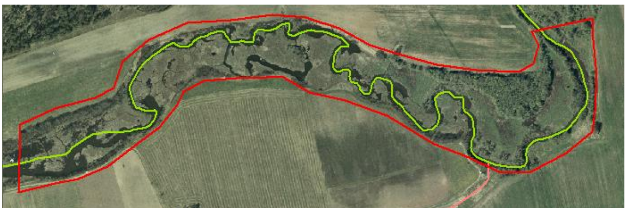
II.4.6. pav. Vadakstis gali pasitarnauti kaip etaloninė upė, nustatant reikalingą laisvos žemės plotą upės vagos meandravimui. Šiame 1 km ruože nekliudomam meandravimui reikalingas plotas apie 16 ha.
