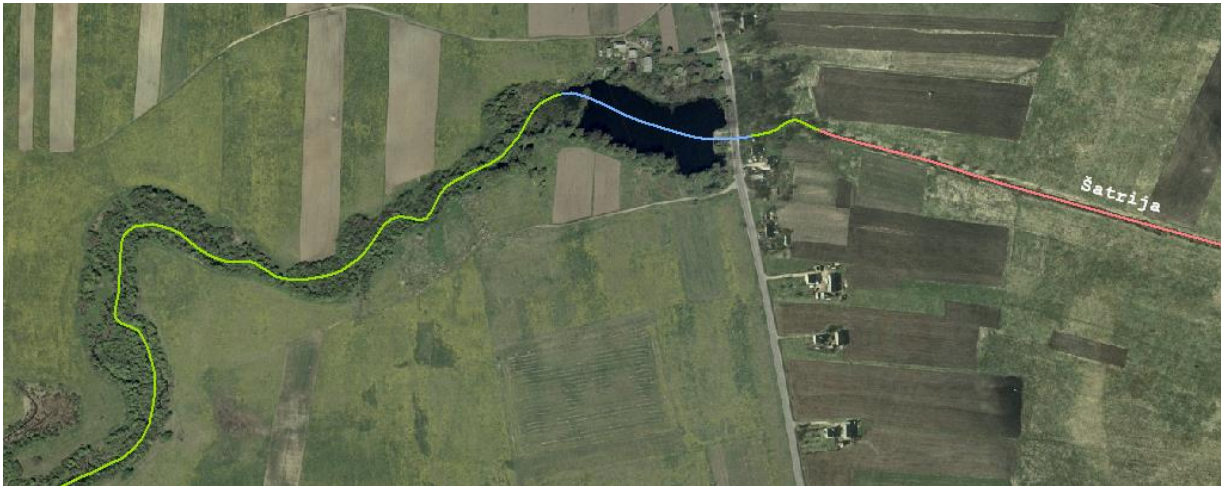
II.4.4. pav. Trys Šatrijos aukštupio (Ventos baseinas) ruožai priskirti atskiroms ištiesinimo kategorijoms: a) žalia spalva – natūralus neištiesintas ruožas; b) mėlyna spalva – tvenkiniu einantis ruožas; c) oranžinė spalva - ištiesintas ruožas.
