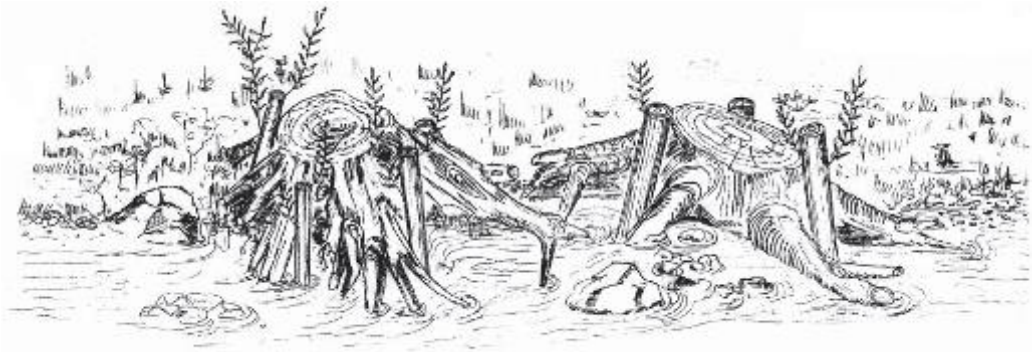
II.7.2.8. pav. Kelmų pritaikymas atstatant upę (Baumann, 2006).
