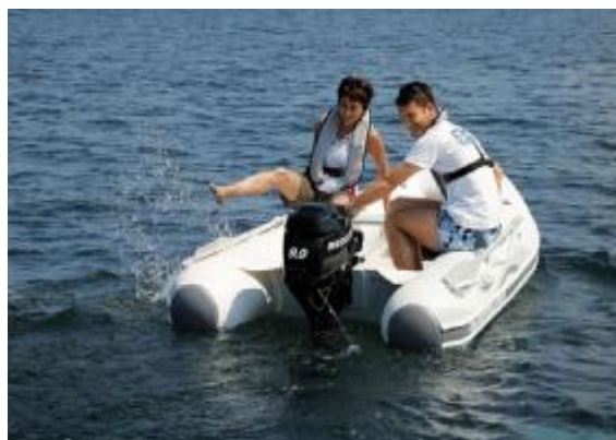
3 pav. Nedidelio galingumo SPP su pakabinamais iki 8 kW galios varikliais
