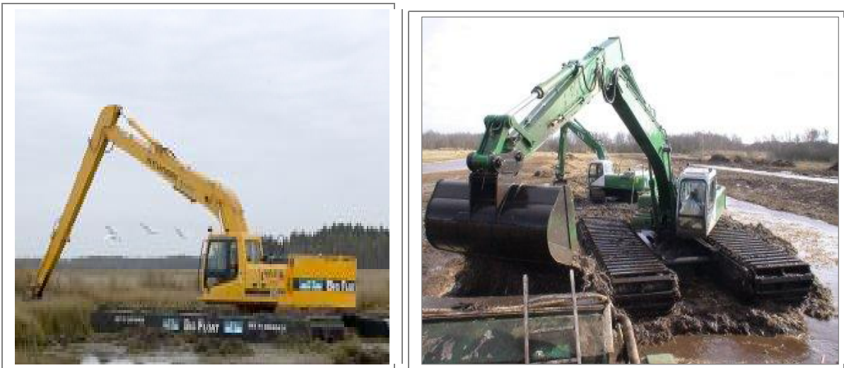
4.15 pav. Ekskavatorius su vikšrais- plūdurais “Big Float” skirtas darbui sunkiai prieinamosse užpelkėjusiose vietose (Nuotr. iš www.bigfloat.com )
