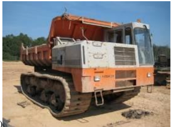
4.13 pav. Savaeigės priekabos CD60R (a) ir CG150 gruntui iš pelkių transportuoti (b) (A.Ciūnio nuotr.)
