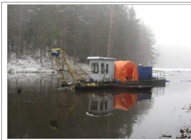
4.3 pav. Žemsiurbės (a) - ZRŠS – 300/20 (siurblys ant denio) ir b) - LŽŪU Vandentvarkos katedros konstrukcijos VT – 2 (panardinamas siurblys) valo ežerus (A.Ciūnio nuotr.)
