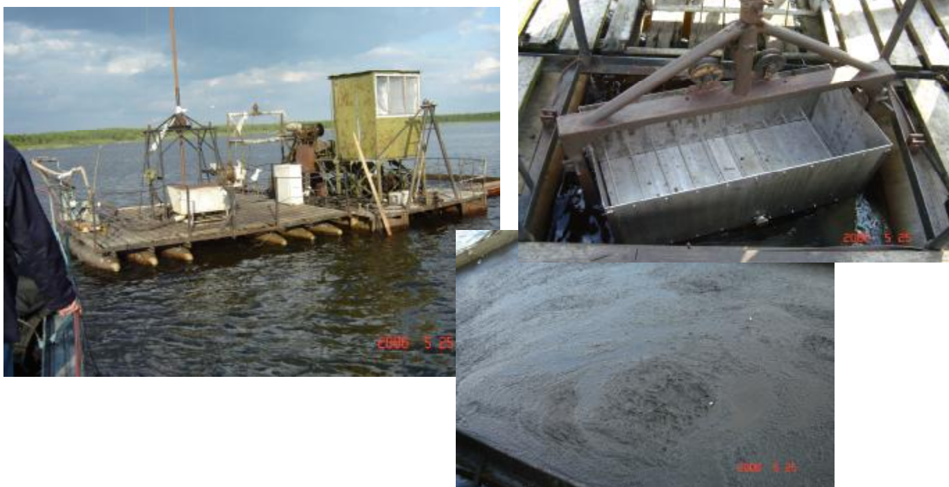
4.16 pav. Sudobol (Baltarusija) ežere naudojama žemkasė su vertikaliai į dumblą išmeigiamu konteineriu (A. Ciūnio nuotr.)
