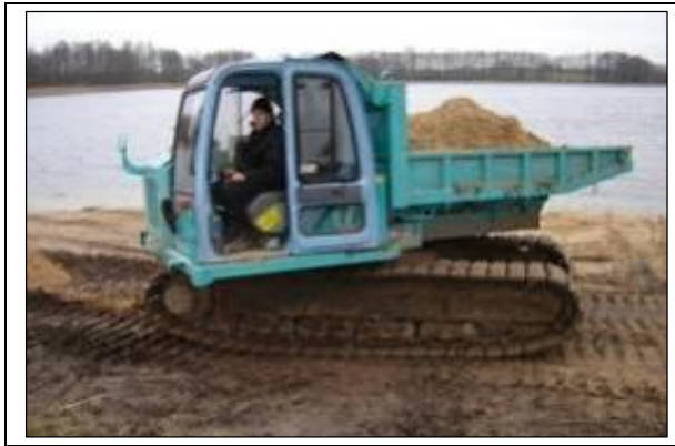
4.13 pav. Savaeigės priekabos CD60R (a) ir CG150 gruntui iš pelkių transportuoti (b) (A.Ciūnio nuotr.)
