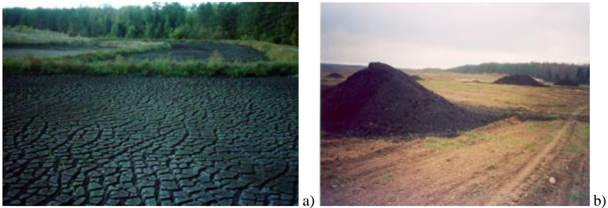
4.7 pav. Sėsdintuvuose sapropelis džiovinamas (a), peršaldomas, vėliau sustumdomas į krūvas (b) (A.Ciūnio nuotr.)
