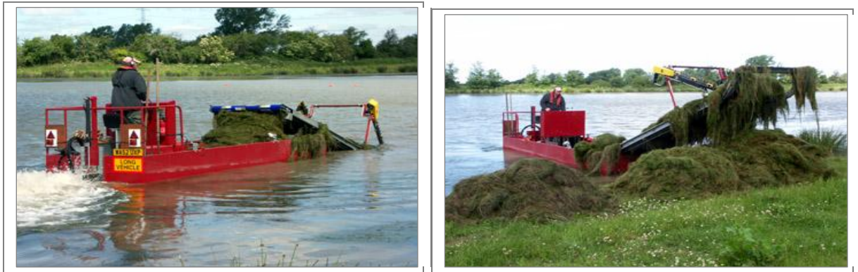
4.22 pav. Makrofitų pjovimo įranga iš karto surenkanti nupjautą biomasę yra daug efektyvesnė (Nuotr. iš www.kingcombe.com )
