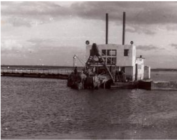
4.8 pav. Žemsiurbė ZGM – 1 – 350 (a) ir rotorinis – kaušinis purentuvas (b) (A.Ciūnio nuotr.)
