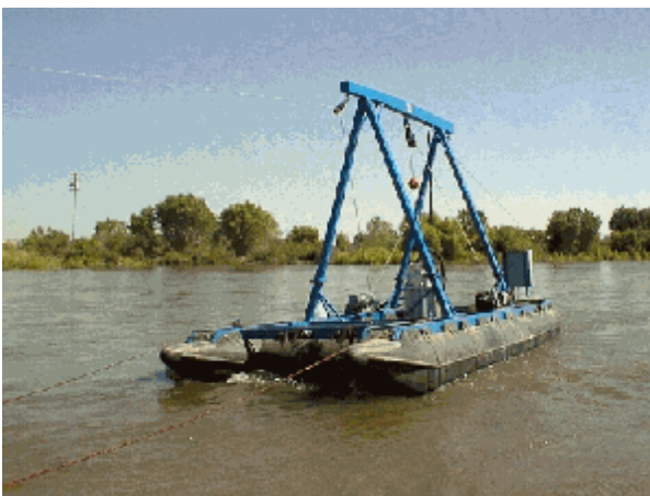
4.9 pav. Nuotolinio valdymo žemsiurbė (a) ir jos panardinamas siurblys (b)
