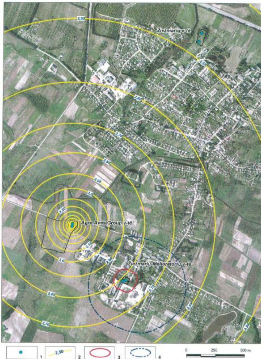
3.3 pav. Prognozinis modelinis AgroAves Group vandenvietės poveikis požeminio vandens lygio padėčiai viršutinio permo vandeningajame sluoksnyje aplinkinėse vandenvietėse 1 - gavybos gręžinys; 2 - požeminio vandens lygio pažemėjimo izolinija, m; 3-4 - Žiežmarių-Melioratorių v-tės apsaugos zonos ribos: 3- VAZ 2 juosta, 4 - VAZ 3 juosta;
