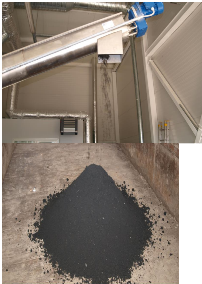
7 pav. Dumblo centrifugos, konvejerio ir nuvandeninto dumblo pavyzdys
