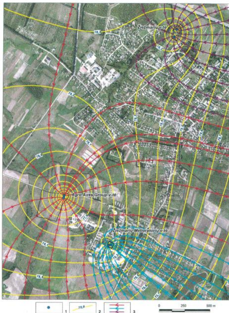
3.2 pav. Prognozinis modelinis viršutinio permo vandeningojo sluoksnio pjezometrinis paviršius, eksploatuojant vandenvietes perspektyviniais debitais
