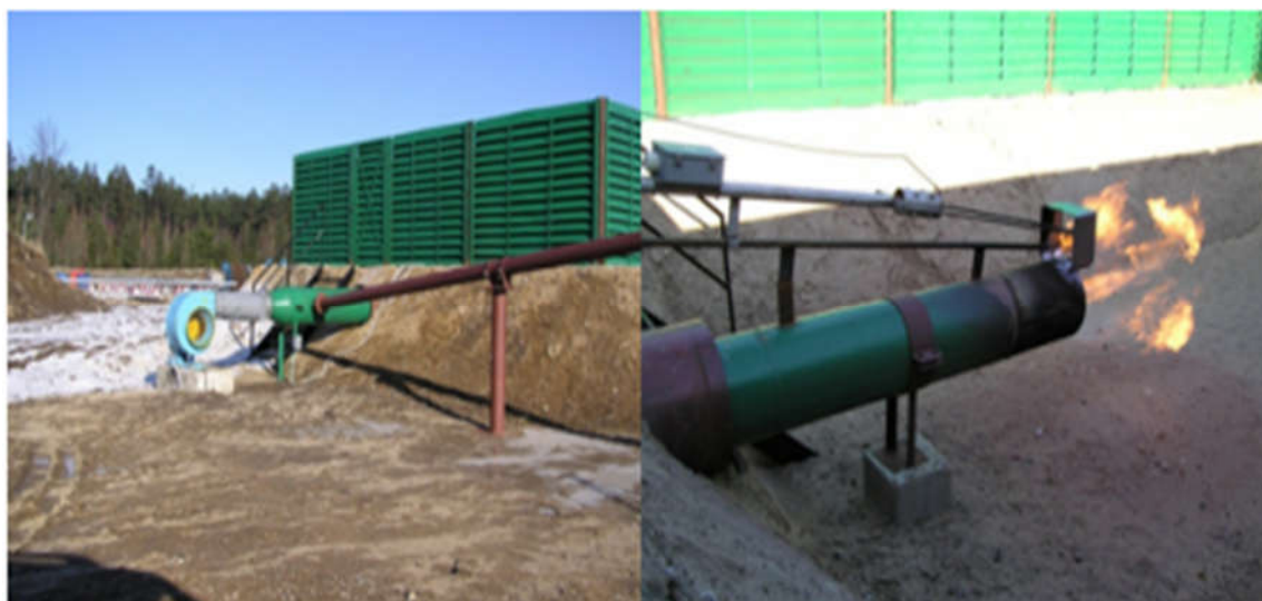
2.1.5 pav. Horizontalus fakelas. Šaltinis: UAB "Minijos nafta" archyvas.
