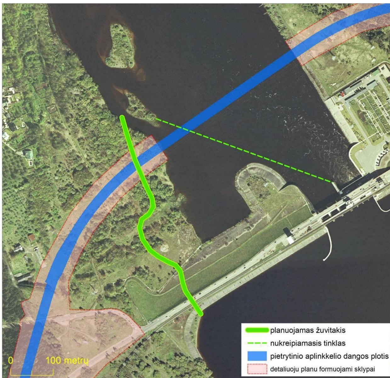
55 pav. Planuojamo žuvtakio schema (pagal UAB „Ekoprojektas“ duomenis)
