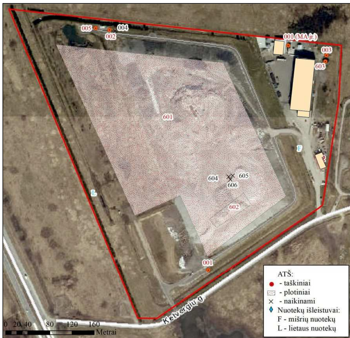
2 pav. Stacionarių oro taršos šaltinių ir nuotekų išleistuvų išdėstymo sąvartyno teritorijoje schema
