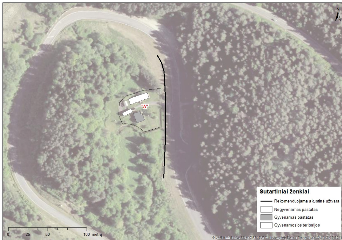
5 pav. Siūloma aplinkos apsaugai nuo triukšmo įrengti akustinę užtvartą su vartais
