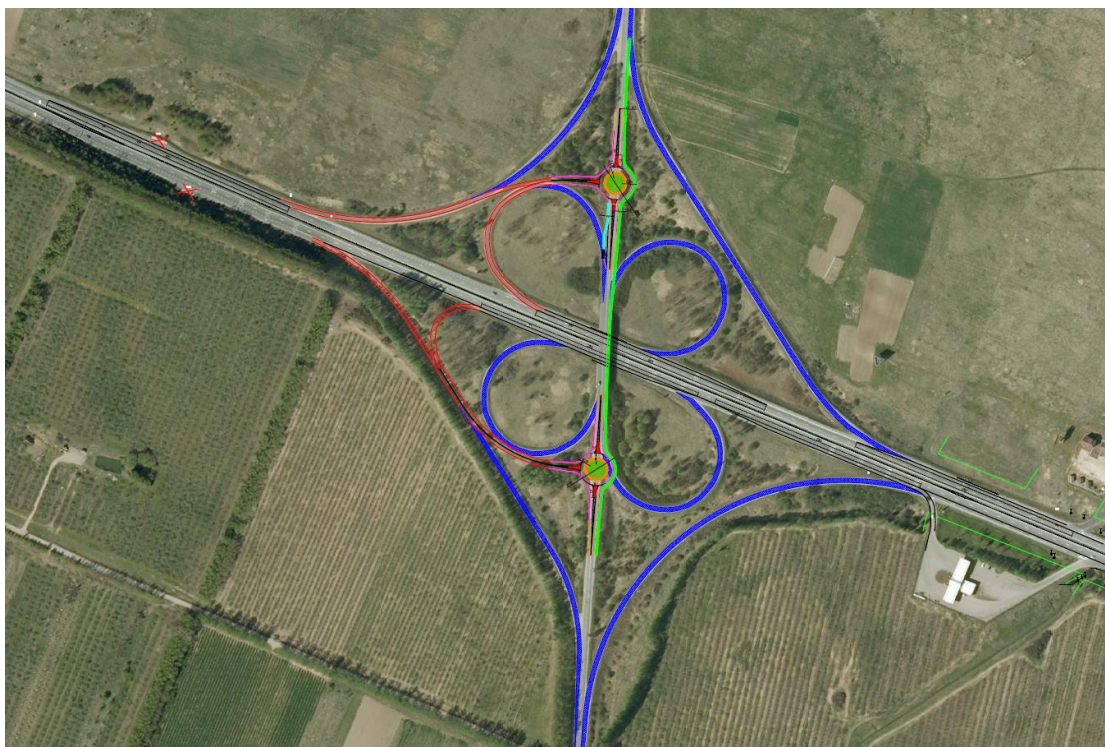
6 pav. Preliminari dviejų lygių Kaišiadorių sankryžos pertvarkymo schema
