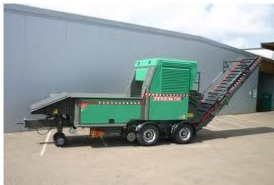
7 pav. Atliekų antrinio smulkinimo įrenginys (plaktukinis malūnas) Jenz BA 725
