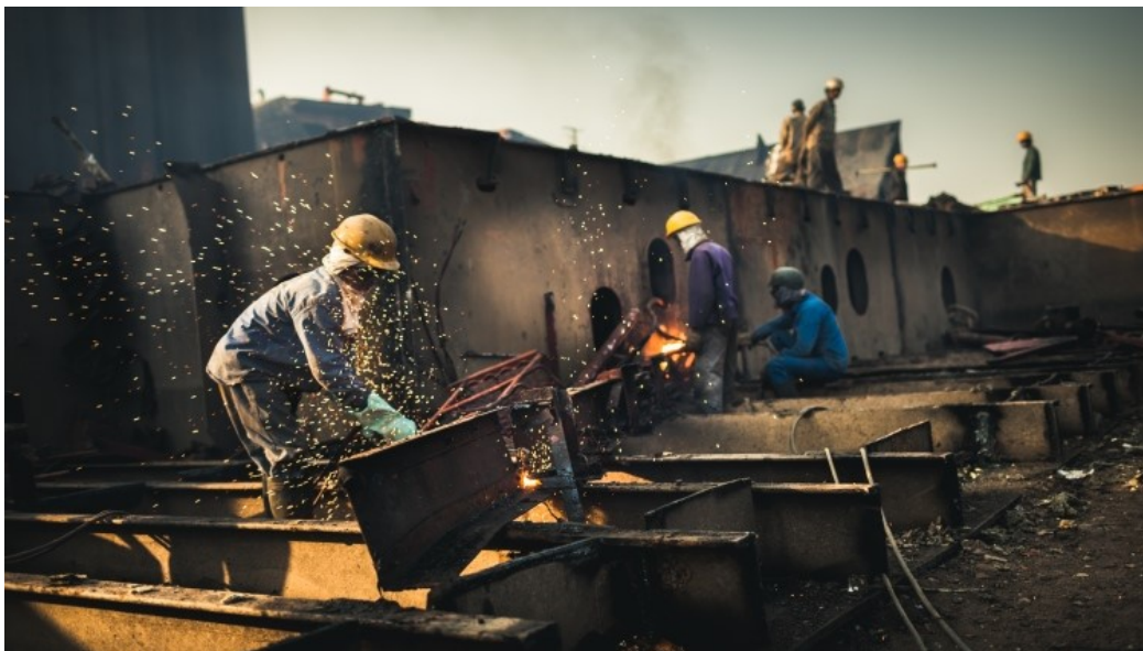
8 pav. Iš laivo iškeltos stambios korpuso dalys smulkinamos ant krantinės (antrinio išmontavimo zonoje B)
