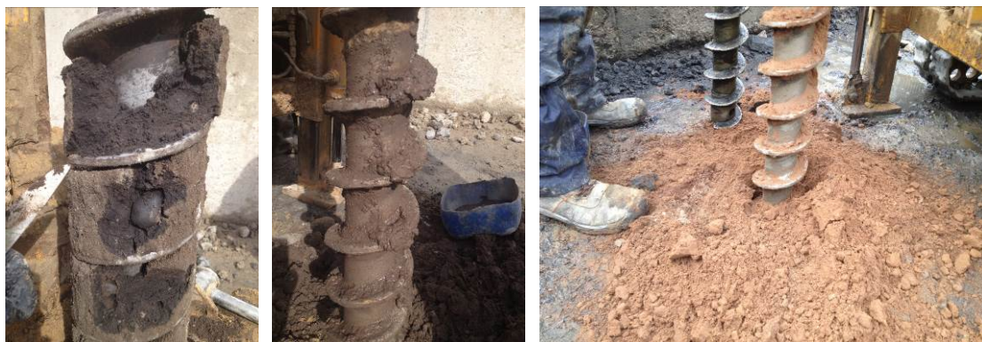
4 pav. Gruntas (iš kairės į dešinę): gręžinyje Nr. P-29 iki 1,0 m gylio ir giliau bei Nr. P-30 gilesnieji sluoksniai.
