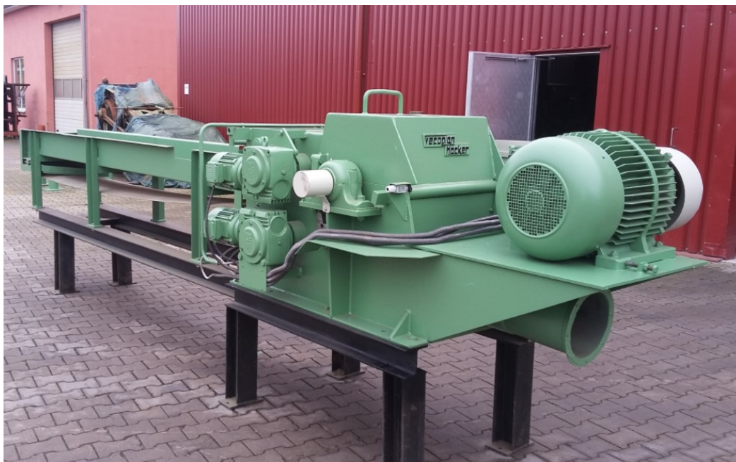
1 pav. Medienos atliekų smulkintuvas „Vecoplan hacker“
